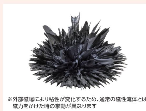
※外部磁場により粘性が変化するため、通常の磁性流体とは磁力をかけた時の挙動が異なります
