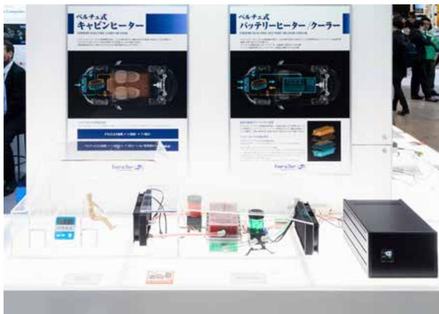
図7 バッテリーおよびキャビンの温調システムのモックアップ
